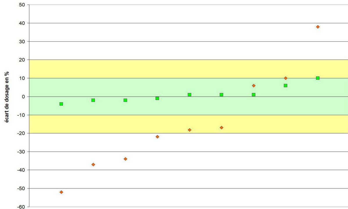
Résultats de dosages du sel en grain obtenus pour 9 machines avant et après réglage
